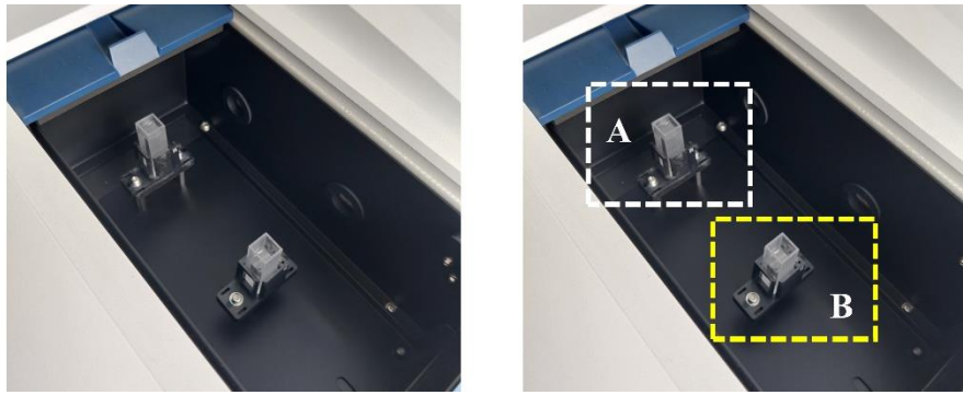
Figura 4.5 Poziționarea cuvetelor în interiorul spectrometrului (A. cuva de referință; B. cuva cu proba de analizat)
