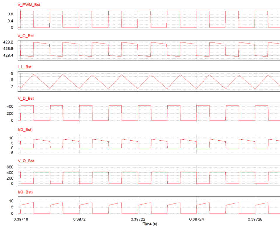
Fig. 5: Formele de undă caracteristice etajului AC-DC surprinzând comportamentul la frecvența de comutație
