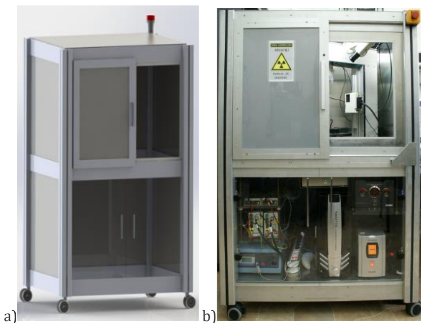
Figura 2.5. a) Randare 3D a proiectului cabinetului b) Imagine de ansamblu a echipamentului de raze X multifuncțional mobil
