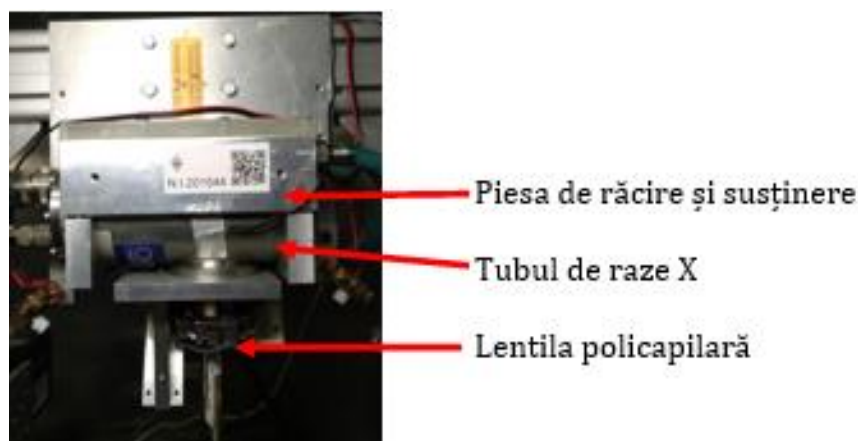
Figura 2.2. Piesa de răcire cu apă și susținere pentru sursa de raze X
