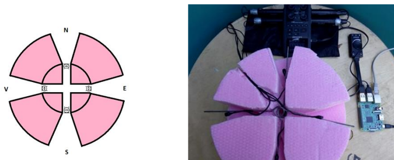
Figura 3: Capul de manechin cu 4 receptori-secțiune orizontală și execuție
