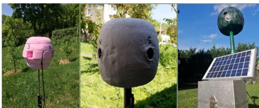
Figura 4: Capul de manechin cu 4 receptori-realizare practică
