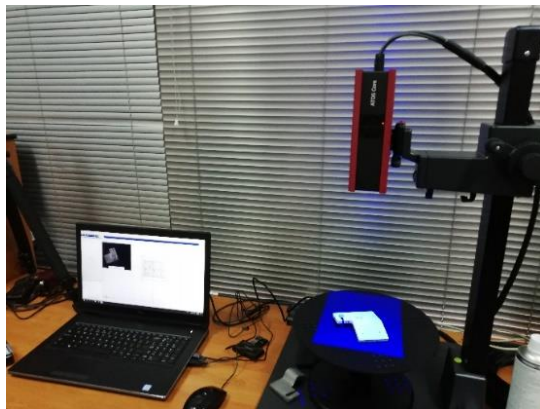
Figura 5.9 Realizarea modelului CAD al pedalei: a) sistemul de scanare optică 3D Atos Core, b) modelul CAD rezultat în urma generării
