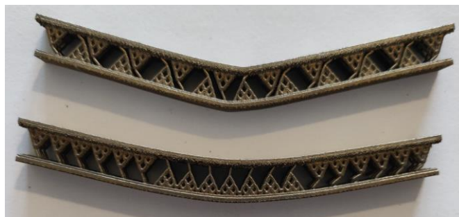
Figura 8. Epruvete S și SJ după încovoiere
