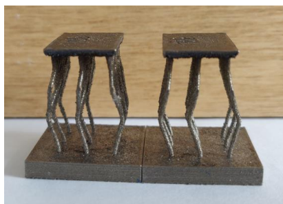
Figura 7. Epruvete S și SJ după compresie
