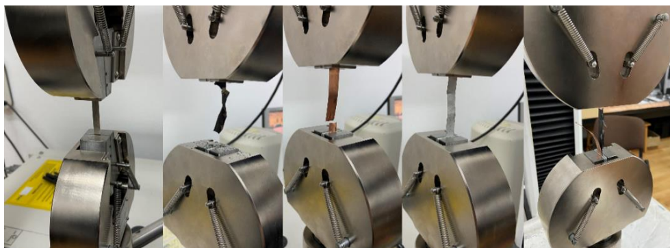
Figura 1. Încercarea de tracțiune a materialelor bateriei ca epruvete individuale sau așezate tip sandviș.
