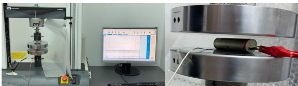
Figura 2. Test de compresie uni axială a bateriei efectuat pe o mașină de testare universală.
